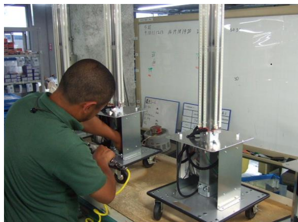
照明器具 配線接続工程
